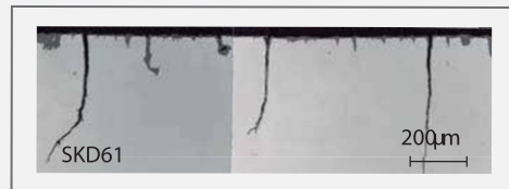
4000 çevrim sonrası oluşan çatlakların kesitleri
